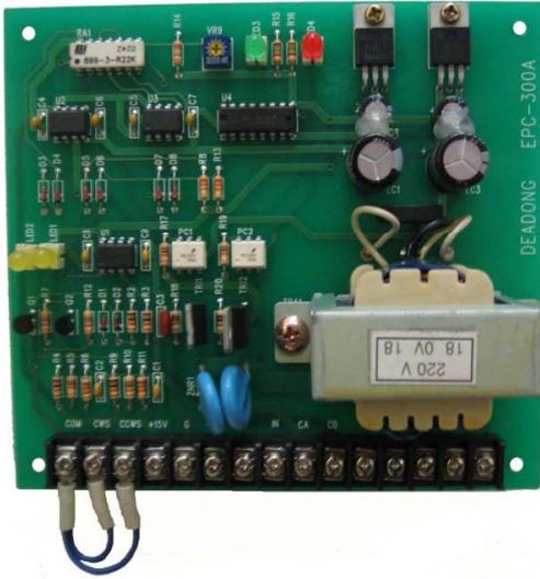
개요 : 단상 Motor 정/역 제어용 Controller로 입력 전압의 신호를 판단하여 Motor를 정/역 제어 하며, 두방향의 리미트 신호를 감지하여 출력을 강제 정지시키는 보호 회로를 내장하고 있다.
