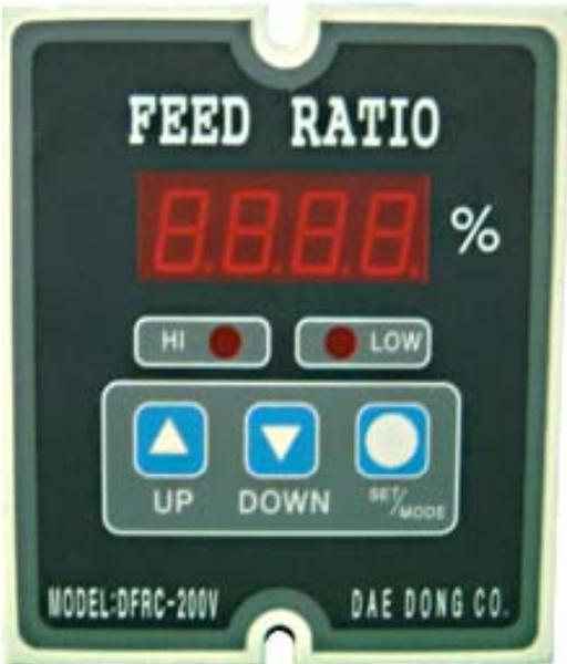
**개요 :** 본기기는 PULSE 및 DC VOLTAGE SIGNAL을 입력하여 F/V, V/V, 로 각각 변환 출력하며 전면 KEY 입력으로 입출력비율을 소숫점 까지 정밀 조정 및 설정할 수 있는 고기능의 변환 설정기 입니다.
