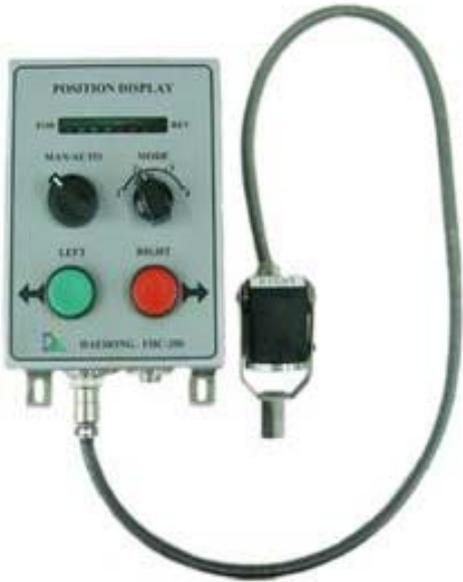
개요 : 본기기는 텐타의 원단 인입부에 부착되어 원단 가장자리 위치를 검출해 정확한 위치에 Pinning이 될수 있도록 레일의 위치를 제어 하는 레일이송용 Motor Driver에 제어 신호를 공급하는 추종 장치. 이와 연계하여 DC Servo Controller (DSC-200)를 제어합니다.
