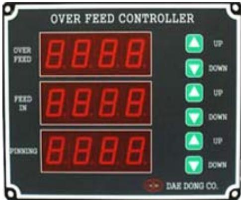
**개요 :** 본기기는 PULSE 및 DC VOLTAGE SIGNAL을 입력하여 F/F, V/F로 각각 변환 출력하며 전면 KEY 입력으로 입출력 비율을 소수점까지 정밀 조정 및 설정 할수 있는 고기능의 변환 설정기 입니다.
